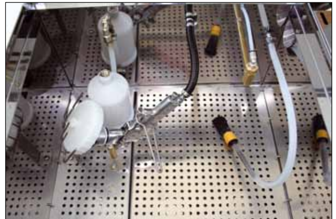
Een snelle reinigungs met de doorstroomborstel
