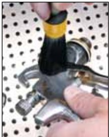
Terugtrekbare borstel. Het oplosmiddel/de reinigungsoplossing loopt door de borstel heen.
